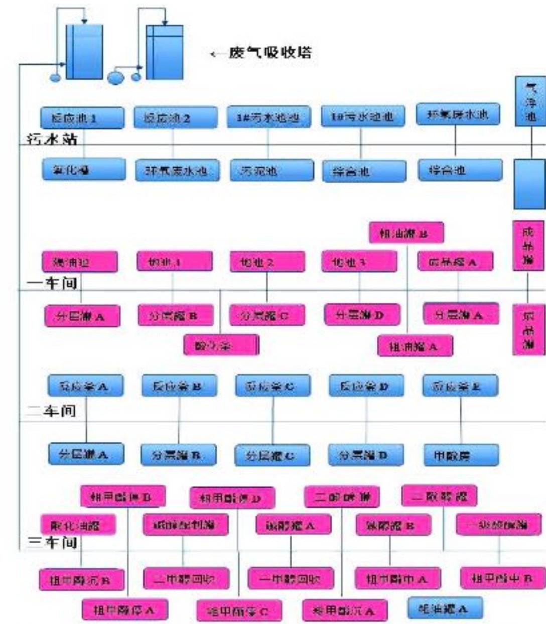
图 4.3.4 厂区废气收集管线示意图
